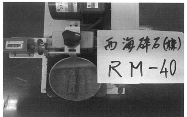
写真4 落下回数10回以上の試料が作製できない状態
