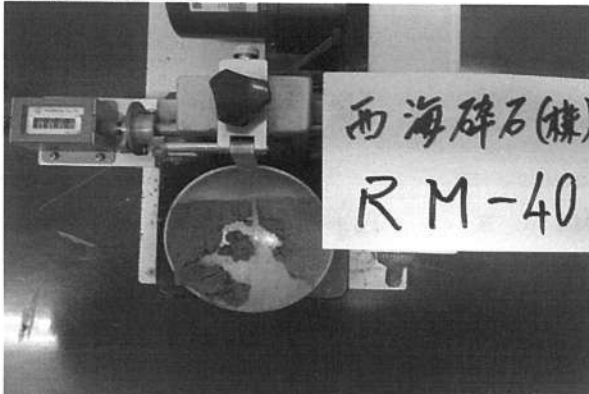
写真3 黄銅皿上での整形ができない状態
